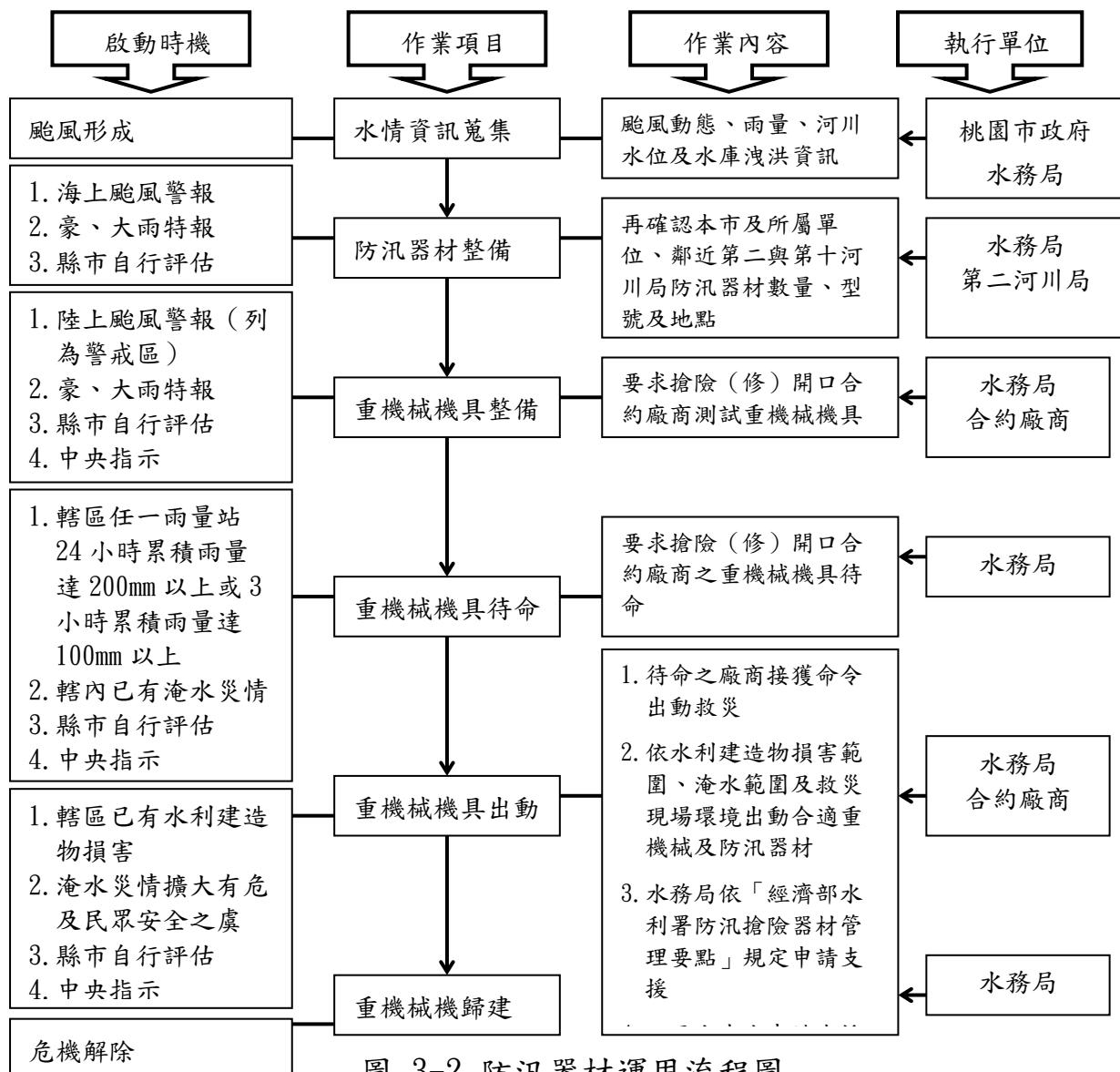
圖 3-2 防汛器材運用流程圖
